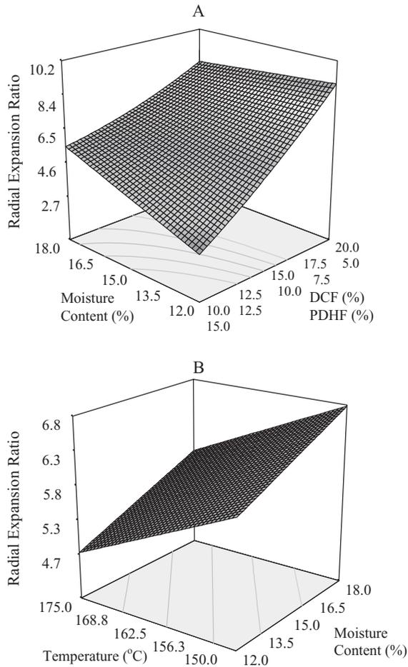
FIG. 2. RESPONSE SURFACE PLOTS FOR RADIAL EXPANSION RATIO
